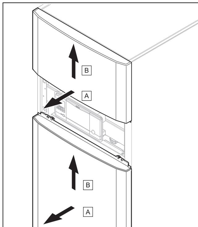
3. Снимите верхнюю и нижнюю часть передней облицовки немного на себя и поднимите ее вверх.
