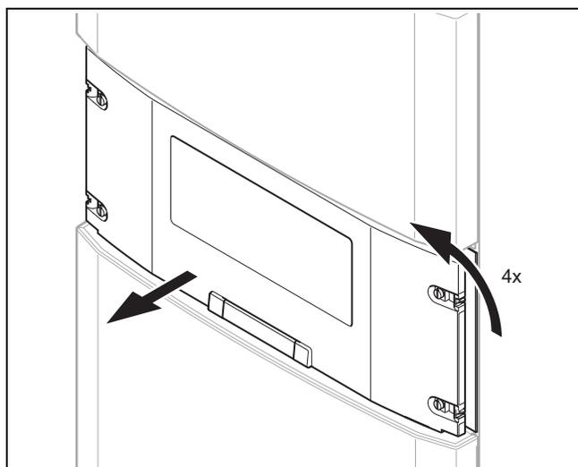
2. Поверните четыре винта на четверть оборота и снимите крышку панели управления в направлении на себя.
