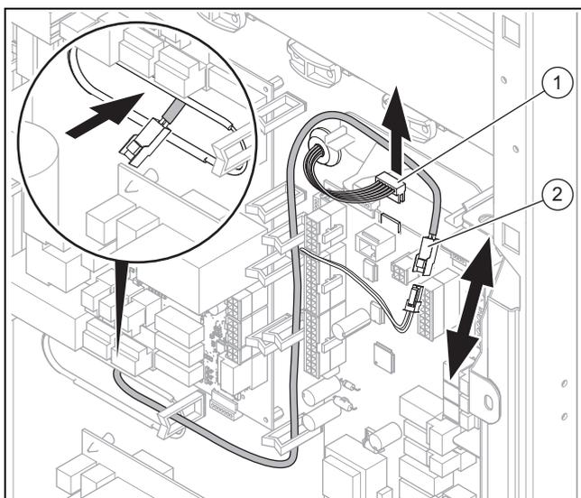
4. Снимите штекер панели управления (1) с электронной платы регулятора и отсоедините штекерное соединение датчика температуры накопителя (2).
