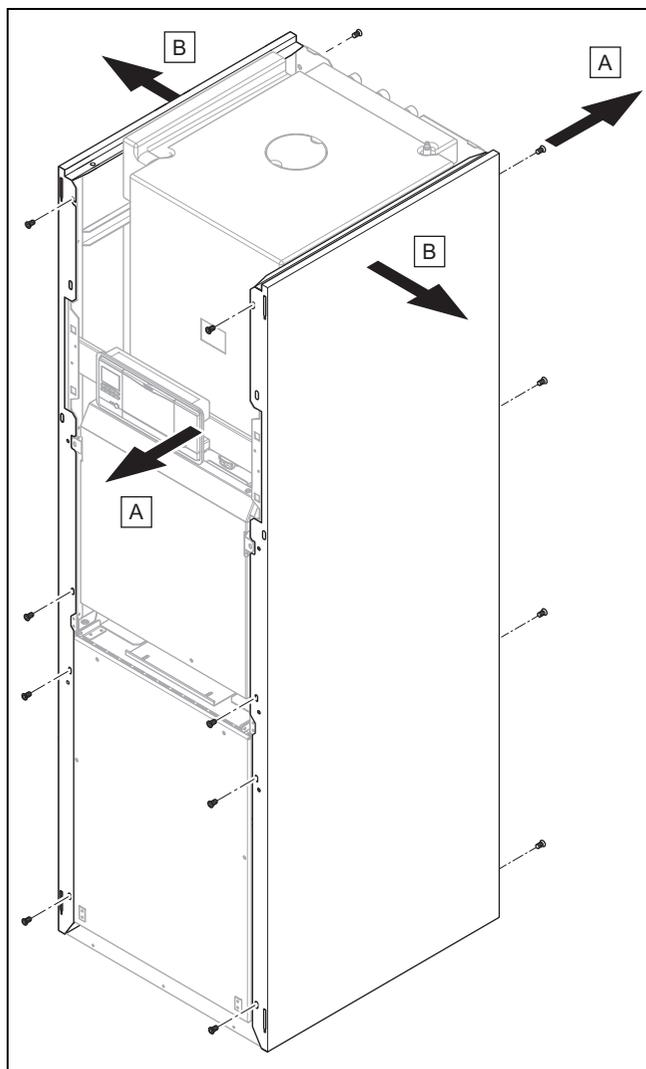
2. Для демонтажа боковой облицовки выкрутите 4 винта спереди и 4 винта сзади.
