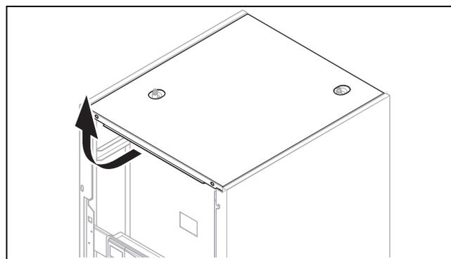
1. Потяните крышку облицовки немного на себя и поднимите ее вверх.
