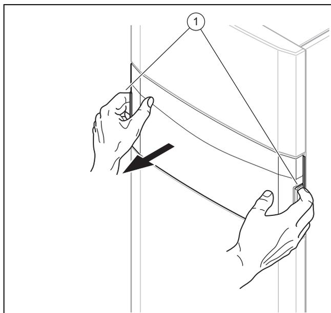
1. Демонтируйте переднюю откидную крышку панели управления, взявшись обеими руками за потайные ручки и снимите переднюю откидную крышку в направлении на себя.
