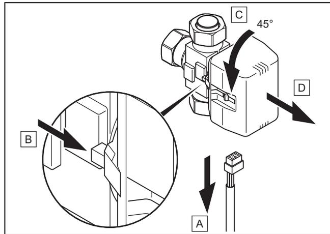
15. Отсоедините кабель электропитания на крышке двигателя переключающего вентиля.
