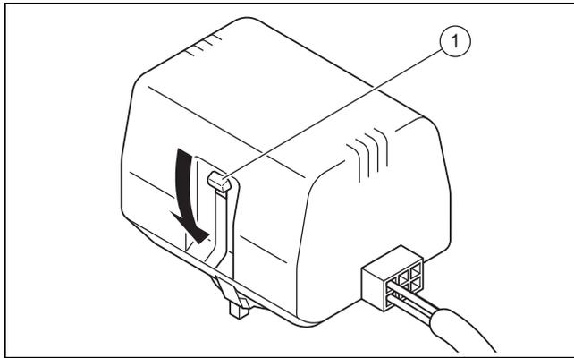
3. Чтобы установить переключающий вентиль отопления/нагрев накопителя в среднее положение, нажимайте на белый переключающий рычаг (1) на крышке двигателя переключающего вентиля, пока он не зафиксируется в своем среднем положении.
