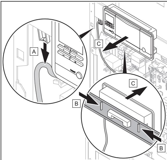
10. Отсоедините кабель панели управления от кабельпровода и извлеките его. Отсоедините панель управления от держателя и снимите ее.
