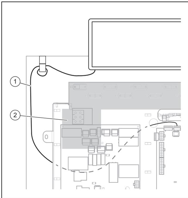
21. Проложите кабель панели управления (1) так, чтобы после откидывания распределительной коробки вверх он находился вне выделенной зоны (2).
