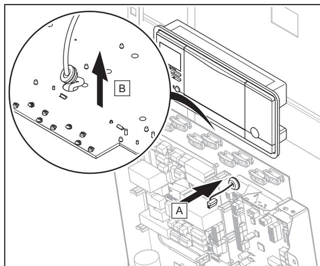
8. Снимите резиновые наконечники с задней стенки распределительной коробки и вытащите кабель панели управления вместе со штекером из распределительной коробки сзади.
