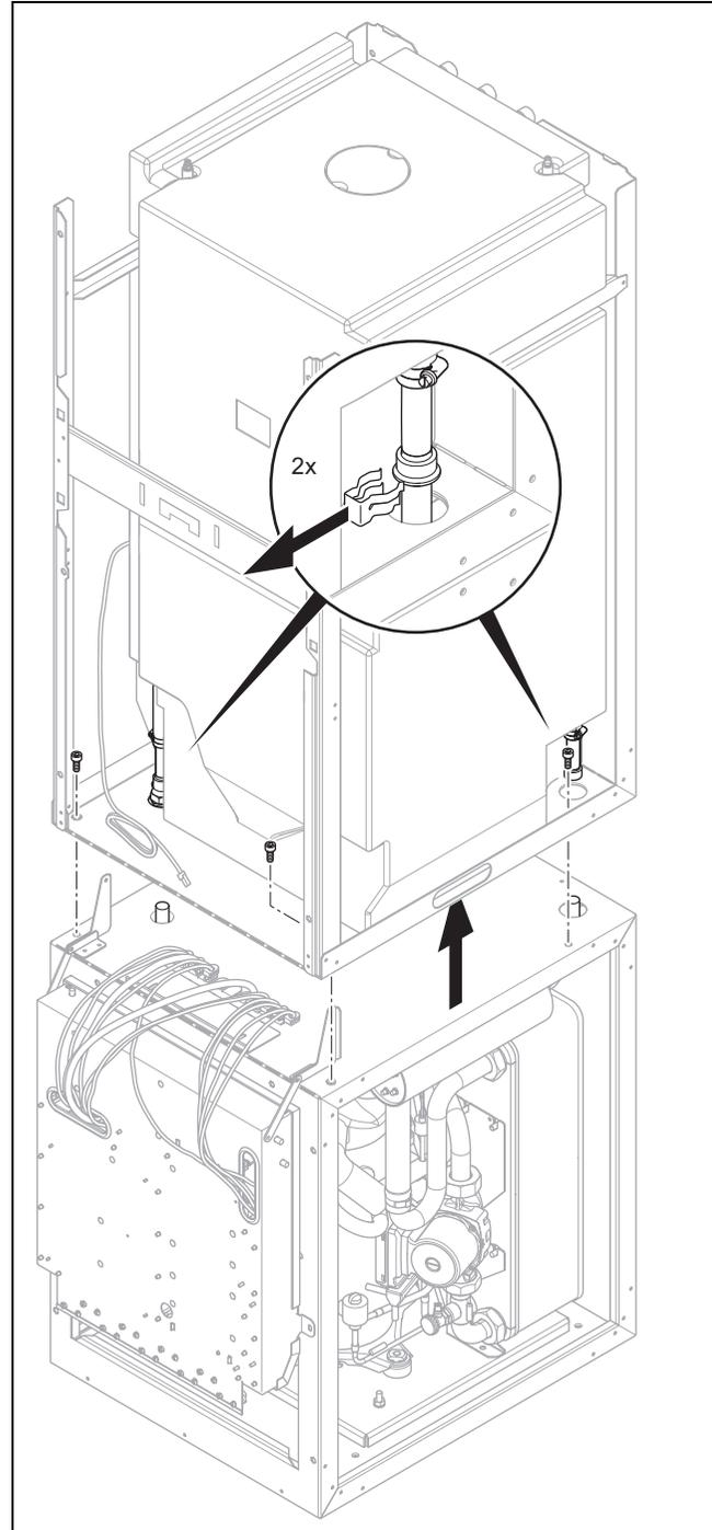
11. Снимите с обеих сторон скобы для соединения подающей и обратной линии системы отопления с накопителем.
