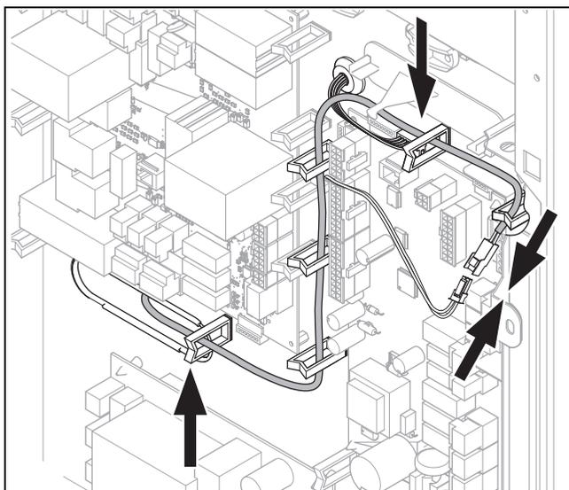
23. Следите за правильной прокладкой кабелей в распределительной коробке и за правильной последовательностью изоляции кабелей на гребенчатой пластине.
