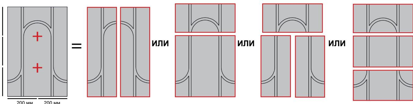
Для начала укладки системы способом «Змейка» (стр. 5) необходимо разрезать пластину пополам вдоль длинного края. Для этого берем пластину, прикладываем линейку, и, ориентируясь на насечки осуществляляем резку. Не пытайтесь разрезать элемент за один проход ножа в глубину. Лучше резать в 2-3 приема.
