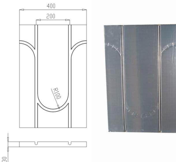
Таким образом, вся поверхность элемента покрыта фольгой, а в местах поворотов контуров (в отличие от известных решений) также осуществляется отбор тепла от труб и передача его чистовому покрытию.
