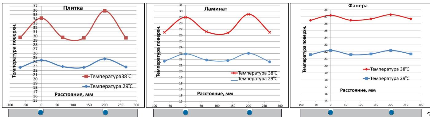
Наблюдается повышенный температурный градиент на полу с плиткой при высоких температурах и больших отопительных нагрузках из-за того, что плиточный клей становится теплопроводящим включением в «пироге» теплого пола, впрямую передавая тепло от трубы к плитке.
